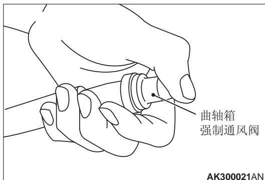
5. 将手指放在曲轴箱强制通风阀的开口处并检查确认能感觉到进气歧管的真空。
