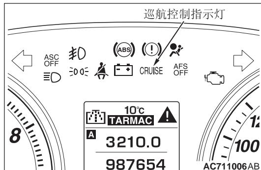
2. 通过观察组合仪表中巡航控制指示灯的闪烁显示模式读取故障诊断代码。
